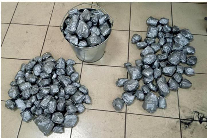
Рис. 4. Образцы породы с «встроенными» в них RFID-метками
