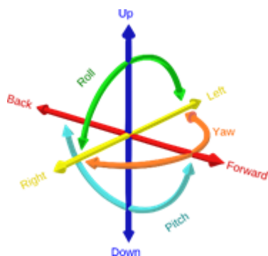
Рис. 1 Графическое изображение параметров координат объекта, вычисляемых алгоритмом визуального одометра
